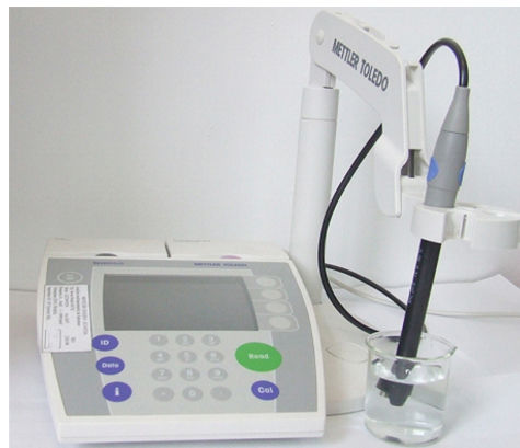
Fig. 1. pH ionometru-conductometru folosit pentru măsurarea probelor.
